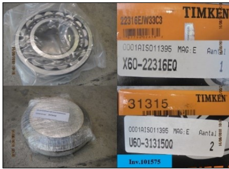
รูปที่ 2.2-1 อะไหล่สำรองของระบบหล่อเย็น
