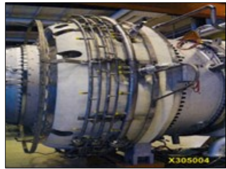
รูปที่ 2.2-2 Dry Low NOx Combustor
