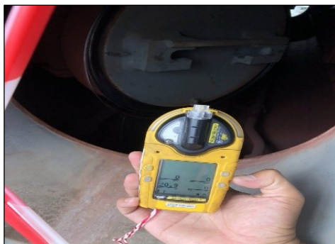
รูปที่ 2.2-28 Gas Detector
